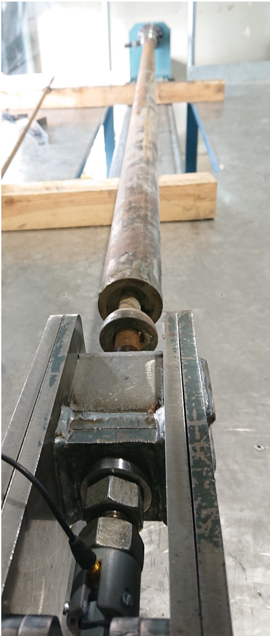
Bild 1: Foto from labbttest vid SWERIM Luleå. Ultraljudsmätning under dragprovning av ingjuten bergbult.
