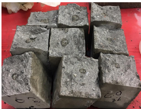
Figur 1. Betong/Bruk med inblandat vattenavvisande medel.
