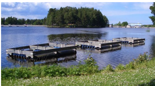
Figur 1 – Flottar för exponering av spruckna stålfiberbalkar i Dalälven (Älvkarleby)
