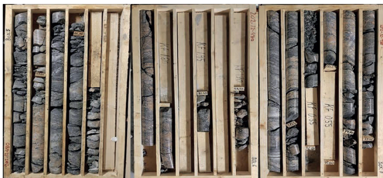
Figur 15. Horisontell borkärna genom den regionala förkastningszonen som visar flera meter av kontinuerlig kärnförlust (träbitar) (från Stille m.fl., 2019).
