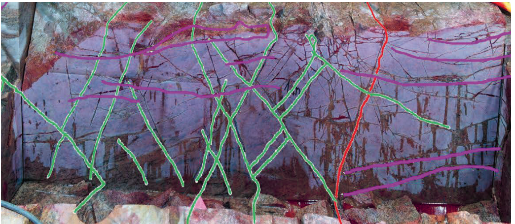
Figur 36. Snittytan TAS04, Sula sektion 25,5 m, riktning in med penetrantvätska samt tolkade spricktyper.
