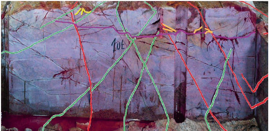
Figur 35. Snittytan TAS04, Sula sektion 25,5 m, riktning ut med penetrantvätska samt tolkade spricktyper.
