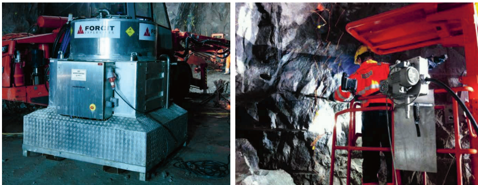
Figur 6. Forcit Laddenhet 201 och laddning med slangdragarenhet i TASJ.
