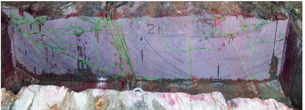
Figur 28. Snittytan TAS04, Sula sektion 34 in med penetranter samt med inlagda spricktyper.
