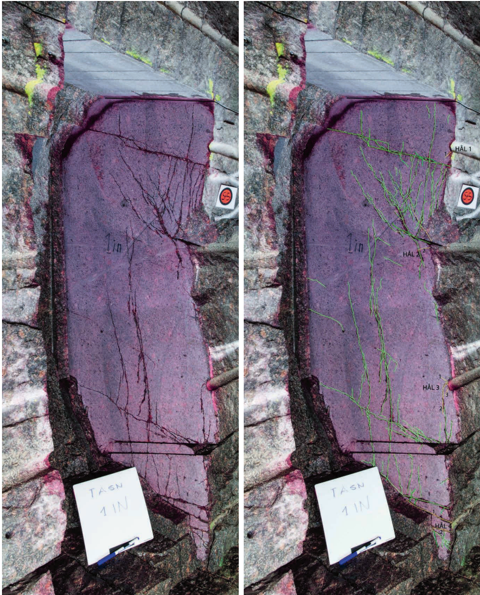
Figur 20. Snittytan TASN in med penetranter samt med inlagda spricktyper.
