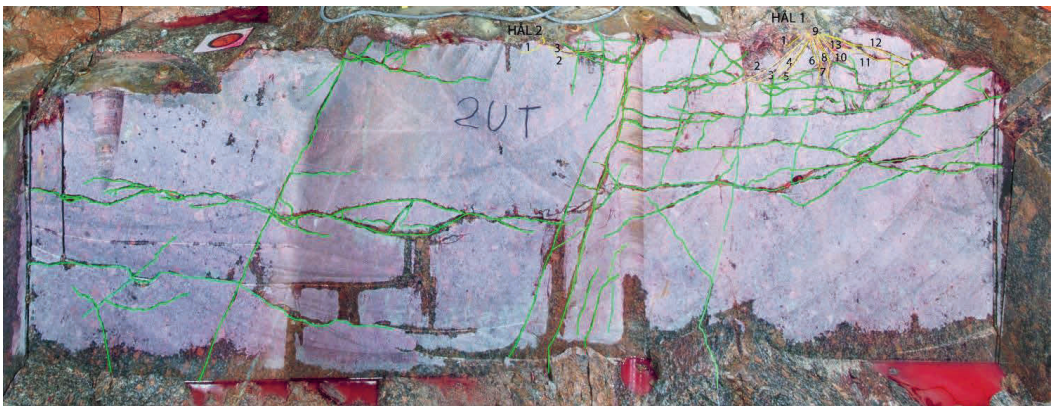
Figur 27. Snittytan TAS04, Sula sektion 34 ut med penetranter samt med inlagda spricktyper.
