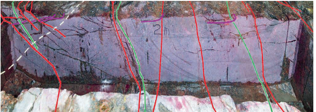
Figur 38. Snittytan TAS 04, Sula sektion 34 m riktning in med penetrantvätska samt tolkade spricktyper.
