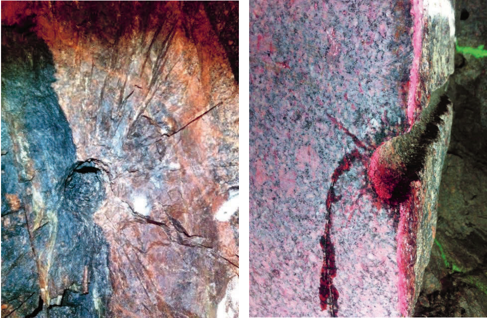
Figur 3. Exempel på sprängsprickor från bottenladdning (till vänster) och kontur (till höger) i TASN, Äspö.
