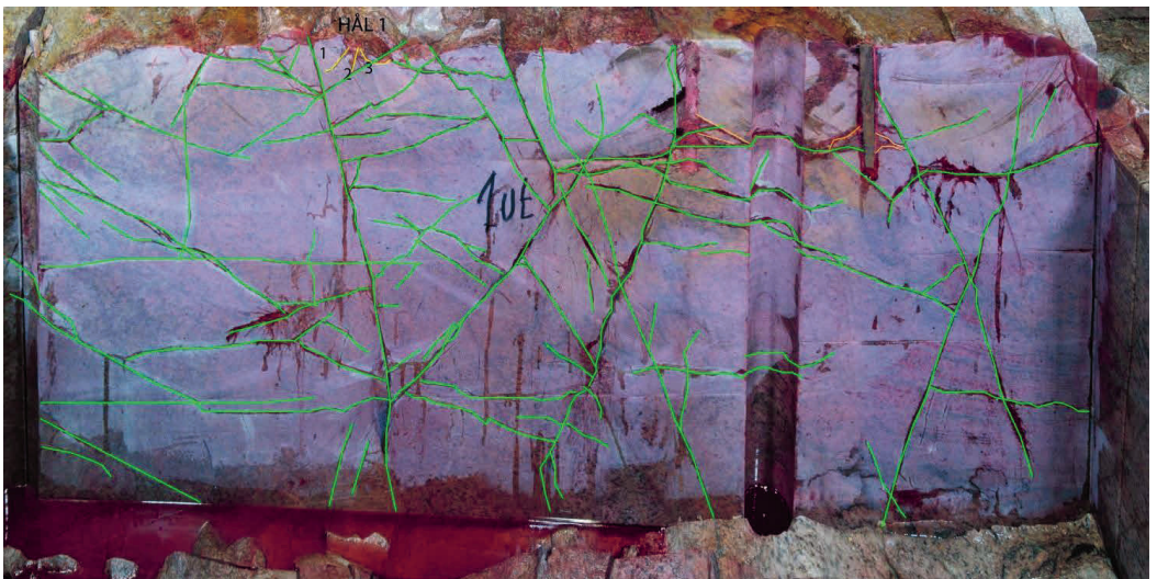
Figur 25. Snittytan TAS04, Sula sektion 25,5 ut med penetranter samt med inlagda spricktyper.
