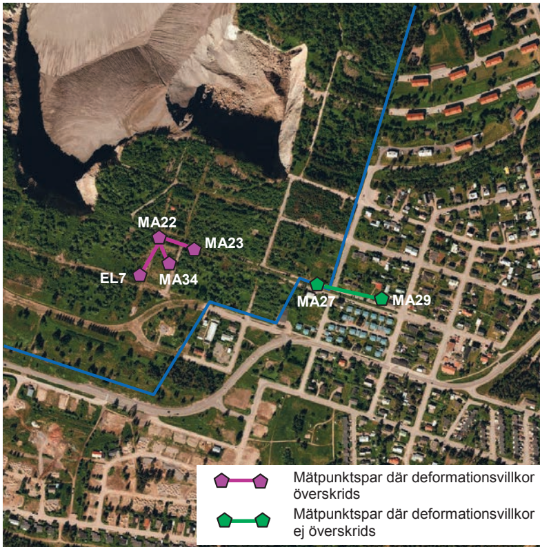
Figur 10 Ortofoto över Fabiangropen, sommaren 2012, visande resultat av kontrollberäkning av nytt deformationsvillkor för Malmberget. Ortophoto of the Fabian cave crater, summer of 2012, showing results of test calculations for new deformation criterion for Malmberget.
