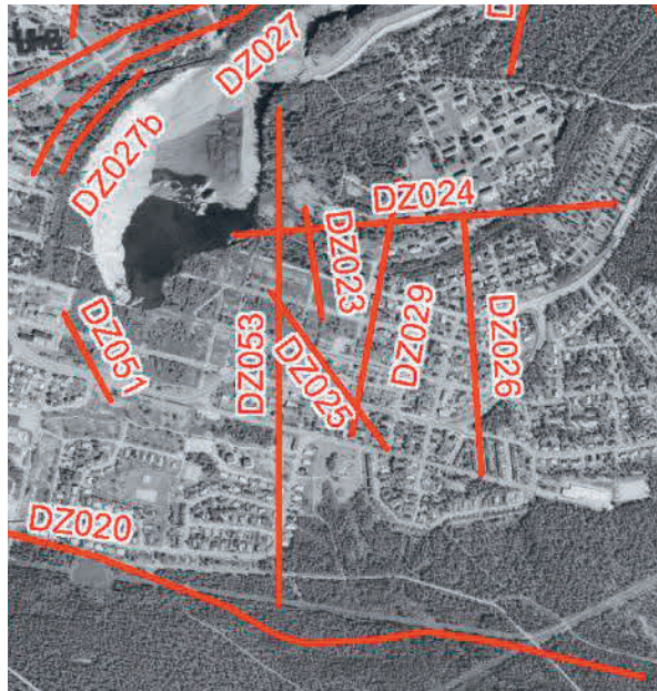
Figur 5 Tolkade storskaliga strukturer (extrapolerade till markytan) i närheten av Fabianmalmen (från Magnor & Mattsson, 2010).
