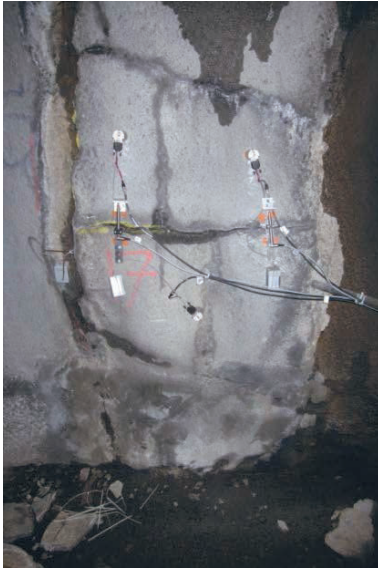
Figur 2. Mätpunkter (LVDT och accelerometrar) på drän prio 1.
