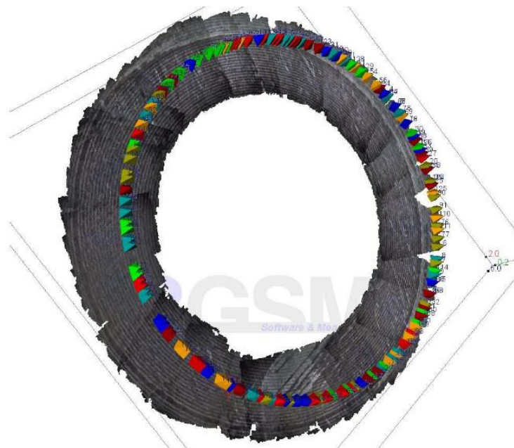
Figur 3. 3D-bild med bestämda kamerapositioner som färgade pyramider (taken from Gaich & Pötsch, 2016).
