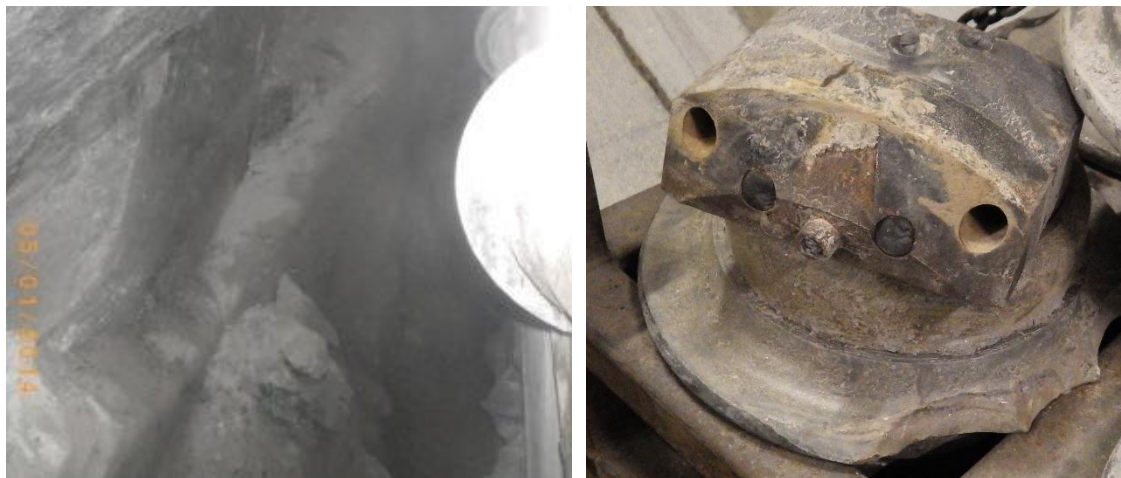
Figure 1. Vänster: Blockig stenmassa. Höger: skadad skivskärare, efter drift under sådana förhållanden.
